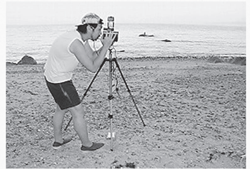
LRF簡易測量機による海岸の測量
