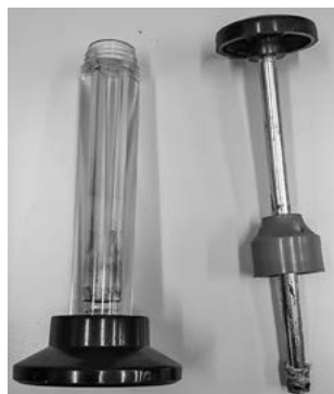
図一、断熱圧縮の実験で使うシリンダー（左）とピストン（右）
