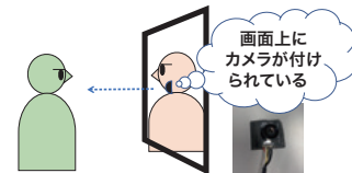
図2. カメラアレイ埋め込み型ディスプレイ(左)と実際に作成したディスプレイ上のカメラの例(右:直径1cm)。
