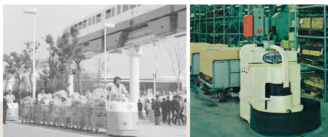
1965年に製造・販売を開始した日本初の無人搬送車「プロントウ」。現在のAGV（無人搬送車）の先駆的存在として、70年の大阪万博で脚光を浴びた
