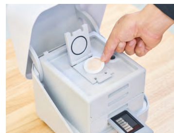
皮膚から蒸散するごく微量の汗を採取したパッチをセットすると、自動的に解析が始まる
