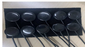
図1 振動子10個を配置した超音波照射用プローブ
