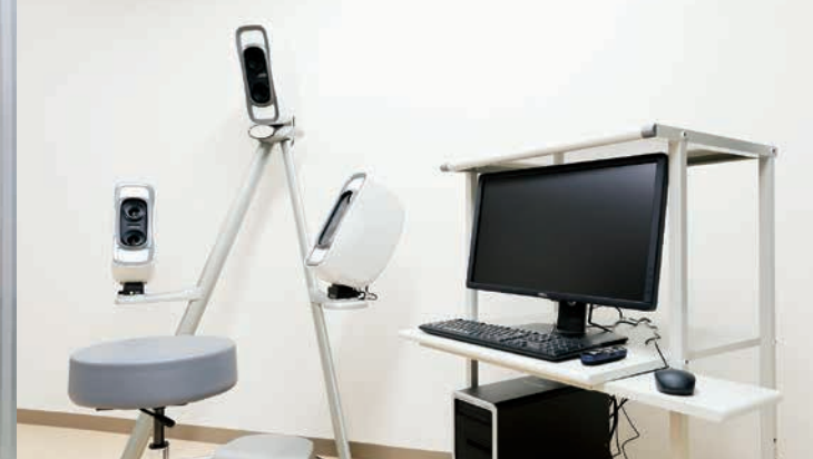
3次元顔画像撮影解析装置 (VECTRA) 人間の顔を3次元で撮影することができ、あらゆる方向から解析することができます。
