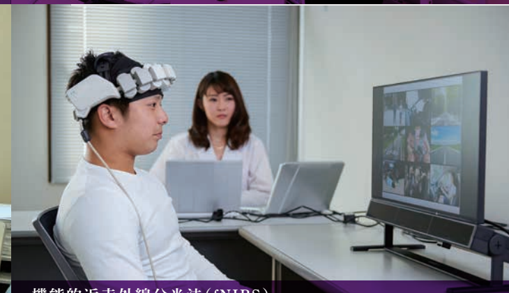
機能的近赤外線分光法 (fNIRS) 生体透過性の高い近赤外光を頭部に照射し、生体内から反射される光の一部を検出することで、脳表面の活動状態を可視化する装置です。
